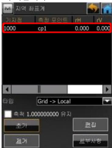
⑥ rH, rV 수평/수직 잔차를 확인하고 잔차가 큰 포인트는 제거하거나 수평/수직 사용 해제를 하여 최적의 잔차로 조정합니다.
